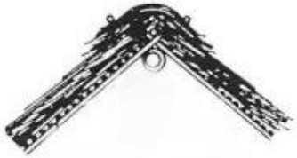
Bambusblätter als Firstsicherung
